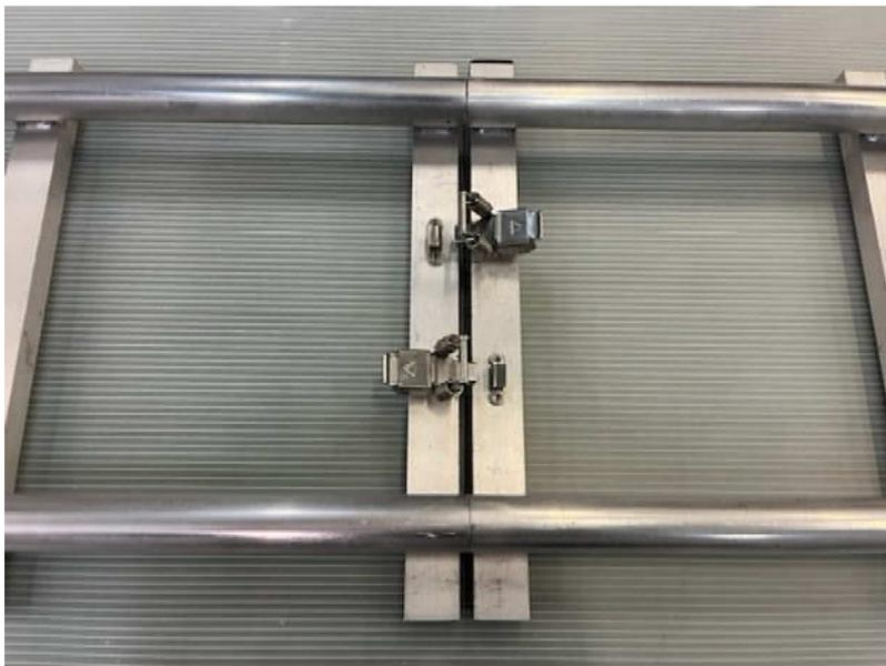
◆連結金具先端部を反対側のアルミレールに引っ掛けて、連結金具後方を矢印の方向に倒します。
